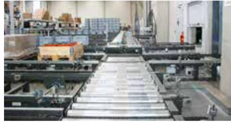
Die Automatisierung des Lagerbetriebes endet im Bereich der Kommissionierung und des Verpackens.
